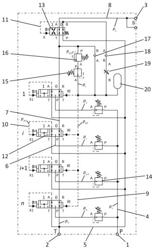
Fig. 3. Hydraulic diagram of the transmitter [Frąckowiak, zgłoszenie patentowe nr P.420408]
